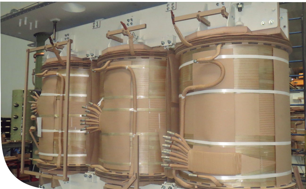
Parte activa del transformador
